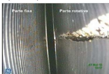
Visión ampliada de la grieta en el anillo en sentido longitudinal
