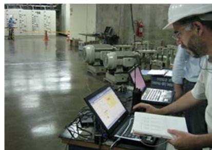
Ensayos del sistema de medición del entrehierro, realizado por ITAIPU, con la supervisión y responsabilidad del CEITAIPU/Voith.
