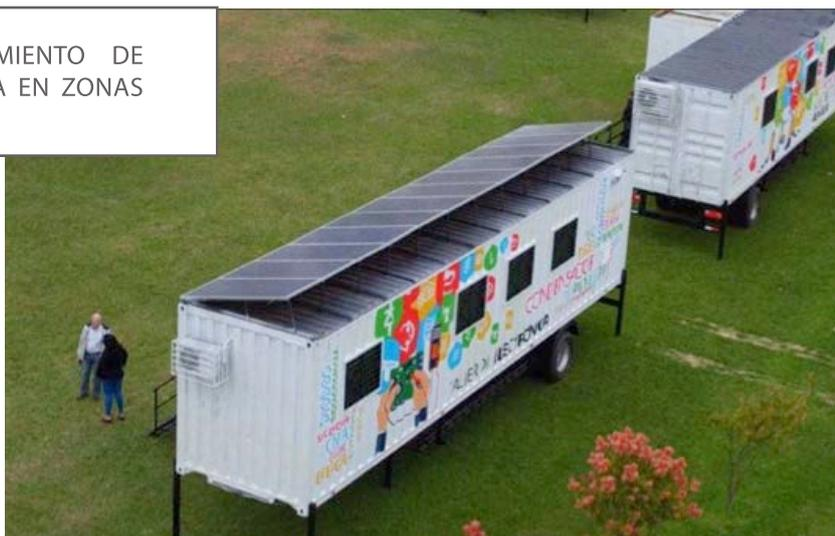
Como innovación de gran relevancia se incorporara al aula para el curso de Electro Electrónica el abastecimiento de energía eléctrica a través de un sistema fotovoltaico consistente en la provisión de energía renovable por medio de paneles solares, inversores y baterías.
