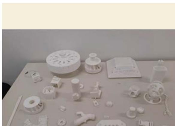
Piezas de muestra fabricadas por la impresora 3D.
