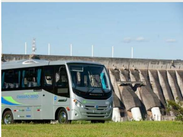
Financiado por FINEP, este proyecto integra diferentes tecnologías: propulsión eléctrica, grupo motor-generator a etanol empotrado, chasis de piso bajo y baterías de sodio, brindando la posibilidad de introducir etanol en el transporte masivo, combinado con la eficiencia de motores y generadores eléctricos (hasta 98%).
