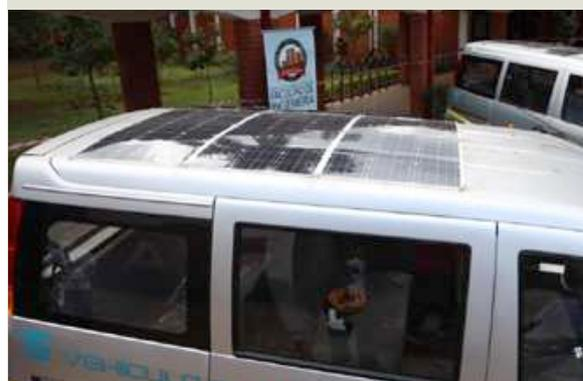
Sistema de paneles solares flexibles para carga de la batería de 12 V.
