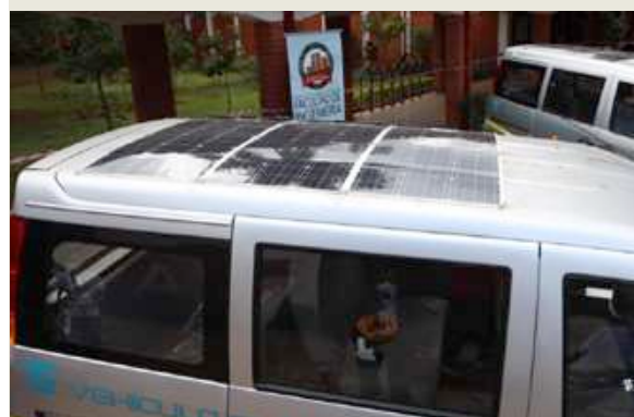
Sistema de painel solar flexível para carregar a bateria de 12 V.
