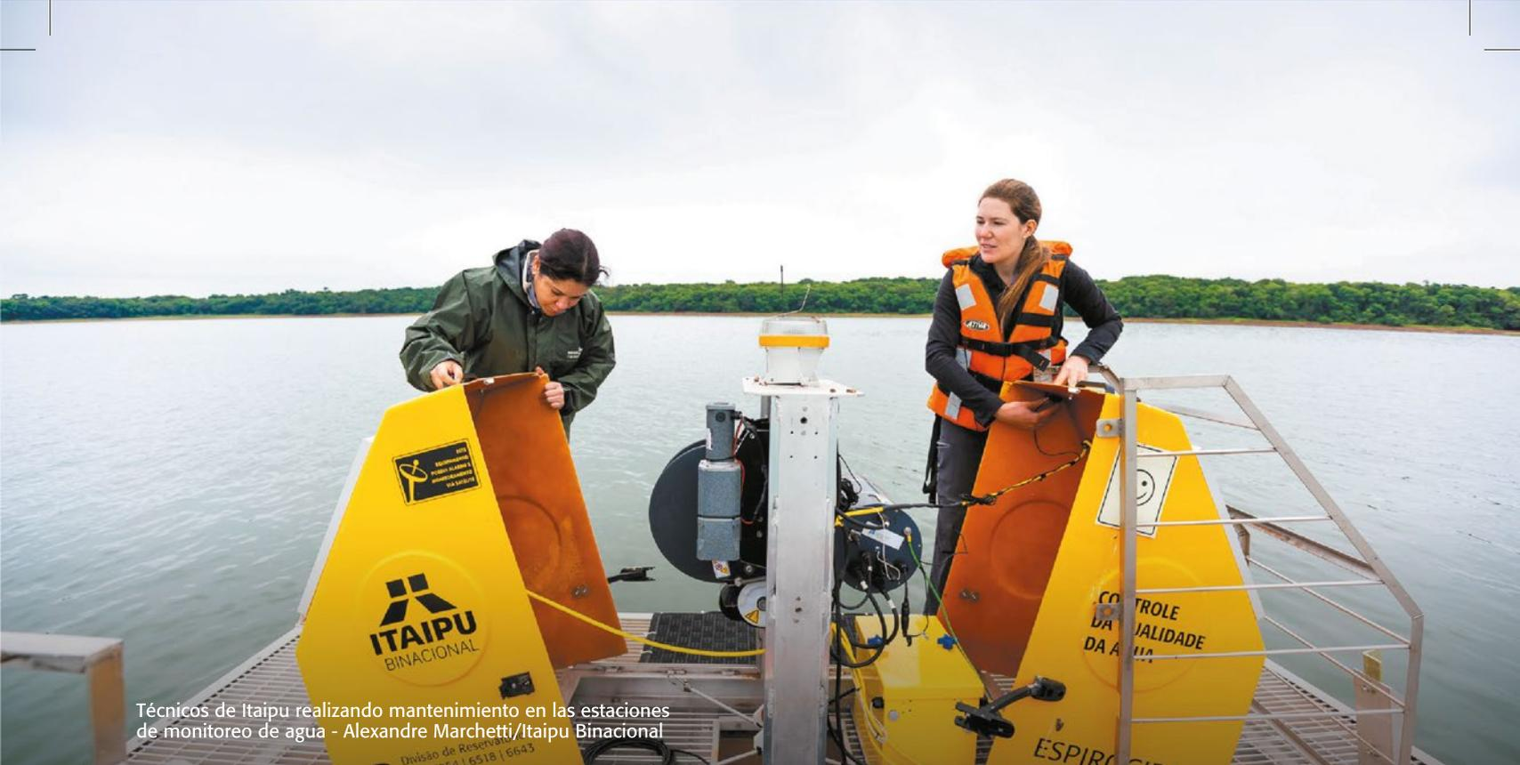
Técnicos de Itaipu realizando mantenimiento en las estaciones de monitoreo de agua - Alexandre Marchetti/Itaipu Binacional
