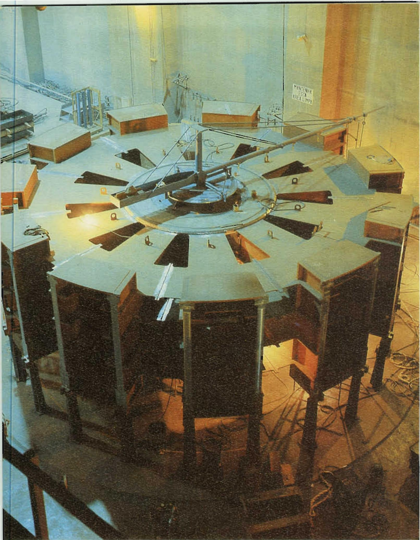
Uma vista da pré-montagem do rotor do gerador n.º 1, na área de montagem direita.
