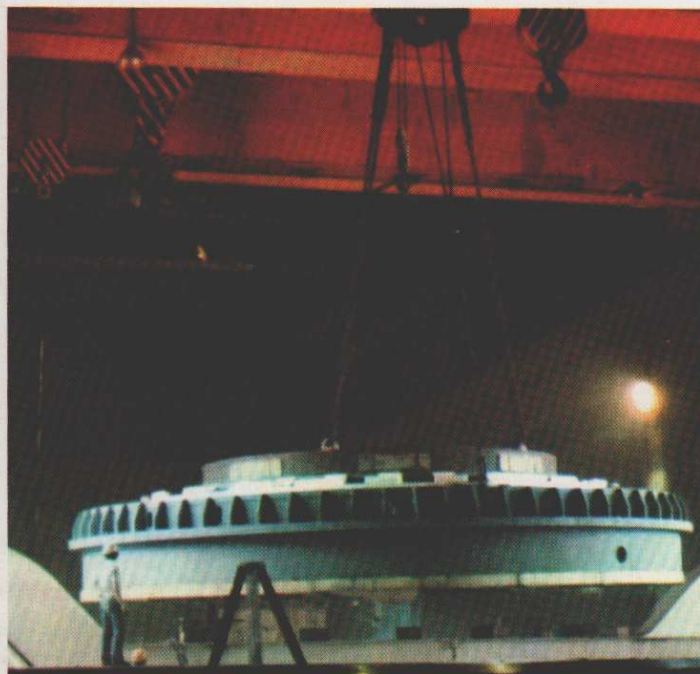
Visão do interior do poço de uma das unidades geradoras, vendo-se instalados vários componentes da turbina.
