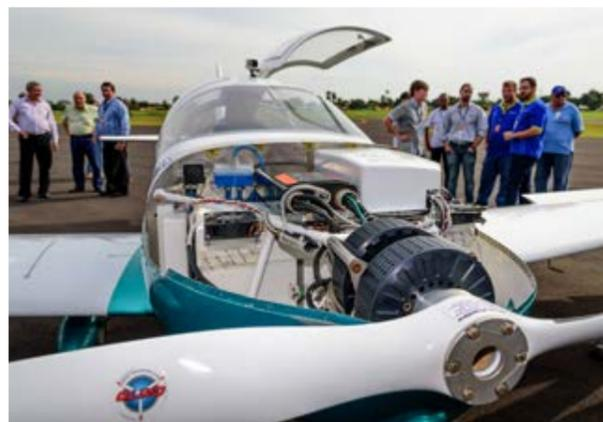
Sora-e é equipado com dois propulsores Enrax, fabricados na Eslovênia.
