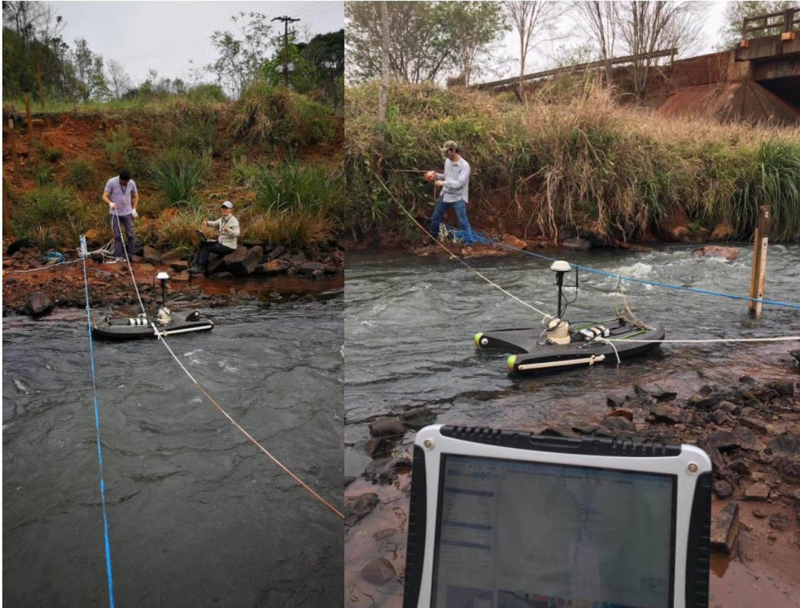
Ilustración 10. Medición de caudal con equipamiento Hidro-acústico Sontek-M9
